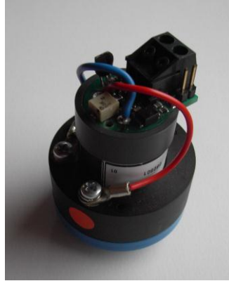
Abb. 1 Sauerstoff-Transmitter mit oberem Ring für Elektronik und unterem Montagering
